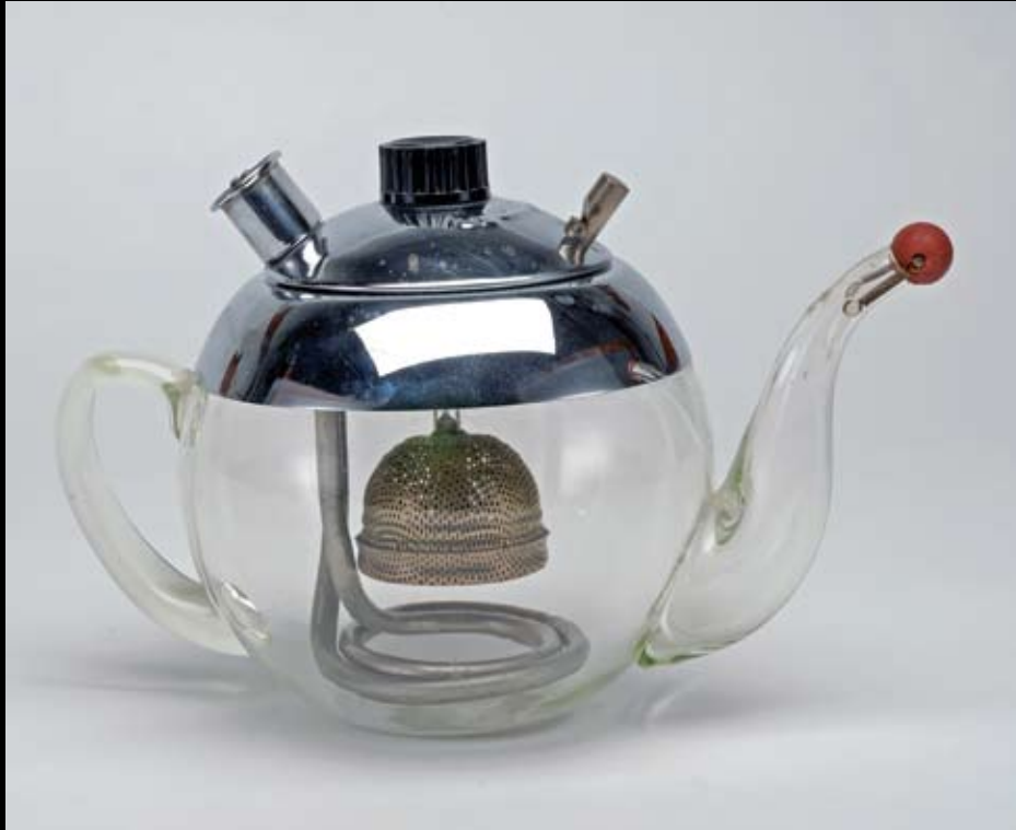
Mandarin elektromos teaforraló kanna Elekthermax gyár, Pápa, 1938 körül, a fémrészen felirat: Mandarin formába fúvott üveg, krómozott rész, bajonettzár, műanyag zárógolyó, elektromos szerelvény 18x30x21,2 cm
